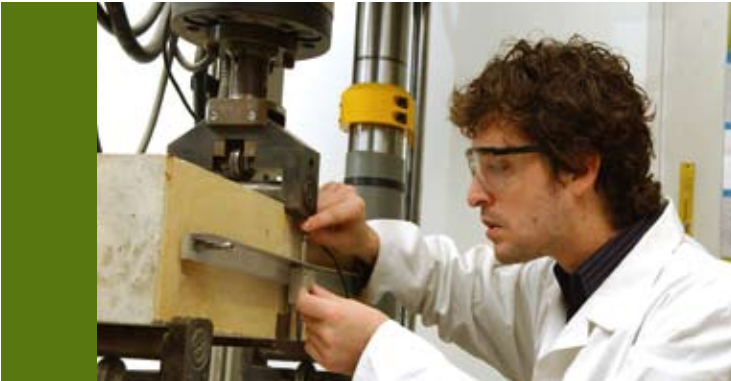
Vorbereiding van een buigproef op staalvezelbeton
