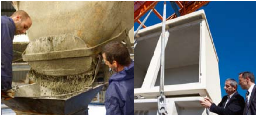
Bij het afladen van met Dramix® Green vezels versterkte beton blijft het mengsel constant homogeen.
