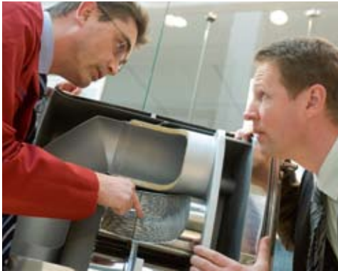
Dieselroetfilter op basis van metaalvezels
