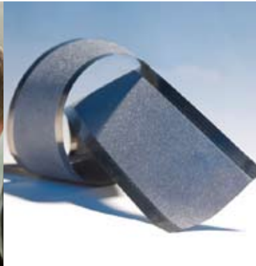
Bekaert metaalvezelmedium voor de filtratie van dieselroetdeeltjes
