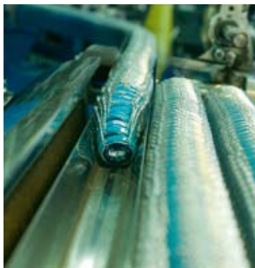
Muselets vervaardigd uit Bekaert draad rollen per 1000 van de band.
