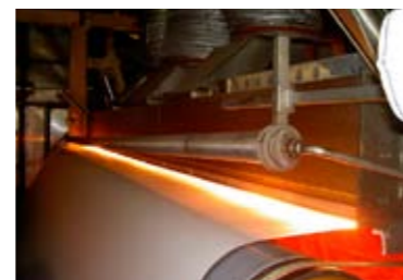
AssiDomän Frövi - Sweden Liquid Packaging Board Bekaert WebMate® M2000+P2200 650 m/min 5.4 MW 6.8 m
