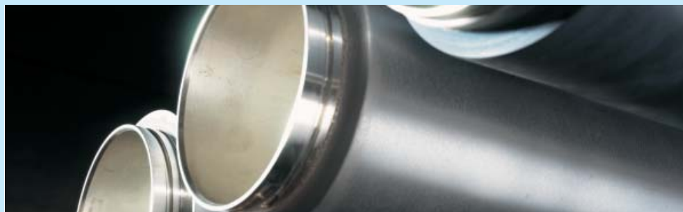
Dankzij roterende sputter targets krijgen glasoppervlakken op een efficiënte manier een deklaag.
