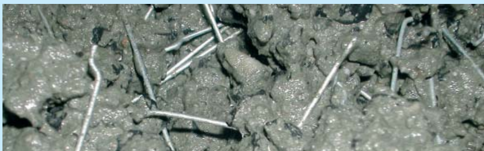
Dankzij Dramix®-staalvezels wordt beton sterker en kunnen scheuren vermeden worden.
