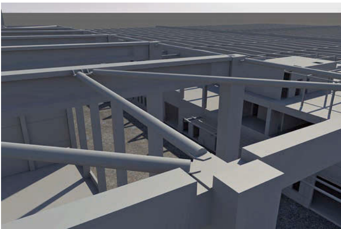
Bild 3. Knotenverbindung der Aussteifungsverbände
