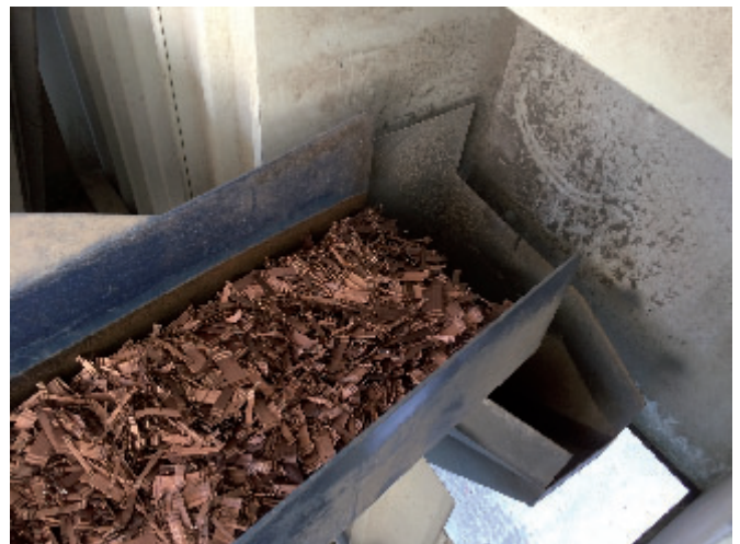
Bild 5. Zugabe der Dramix® 5D 65/60BG Fasern mittels Dosieranlage Titelbild: W+P Weber und Partner AG (B. Santos) Übrige Bilder: Bekaert (Schweiz) AG
