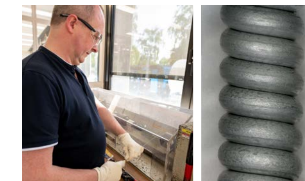
Bezinal®-Drähte 80fache Vergrößerung
